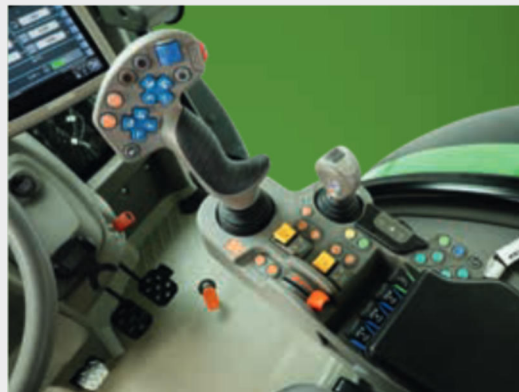
↑ Einfache Bedienung der Steuerventile über die MaxCom-Bedienarmlehne.
