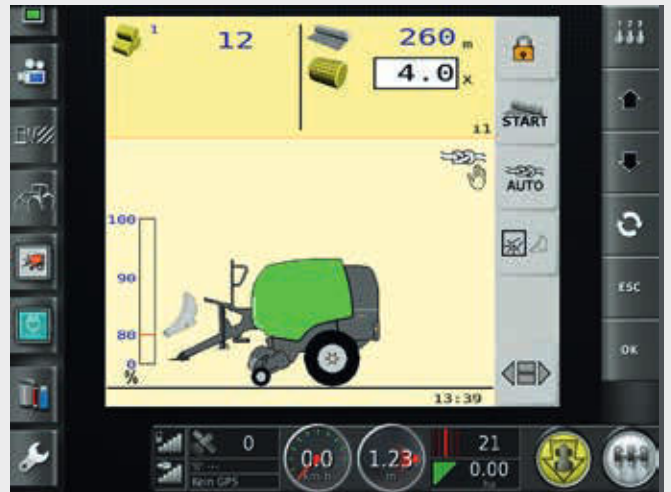
Universal-Terminal zur Steuerung beliebiger ISOBUS-Geräte.
