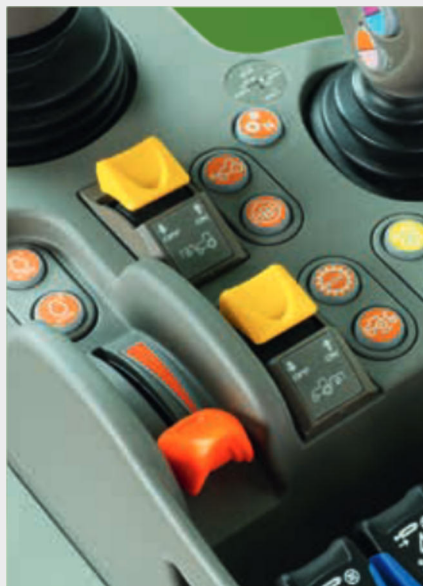
↑ Einfaches Einschalten der Front- und Heckzapfwelle durch Tasten auf der MaxCom-Armlehne.
