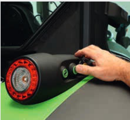
↑ Heckkraftheber und Zapfwelle können mit externen Bedienelementen an den hinteren Kotflügeln gesteuert werden.
