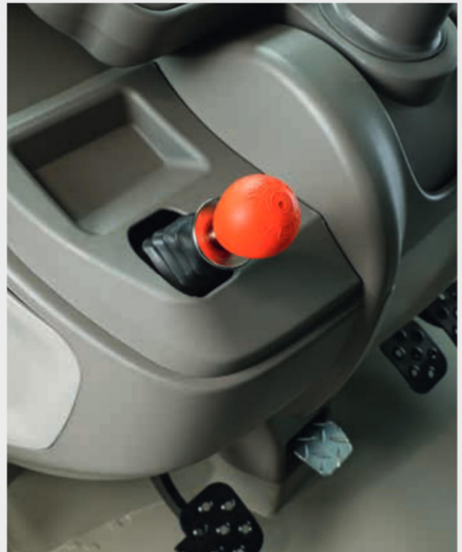
↑ Sicheres Parken auch in hügeligem Gelände dank der leistungsstarken HPB-Feststellbremse.
