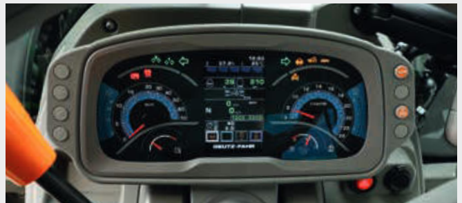
↑ Die analog-digitale Instrumententafel liefert die wichtigsten Traktorfunktionen auf einen Blick.
