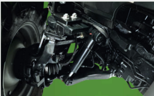
↑ Gefederte Vorderachse mit Einzelradaufhängung.
