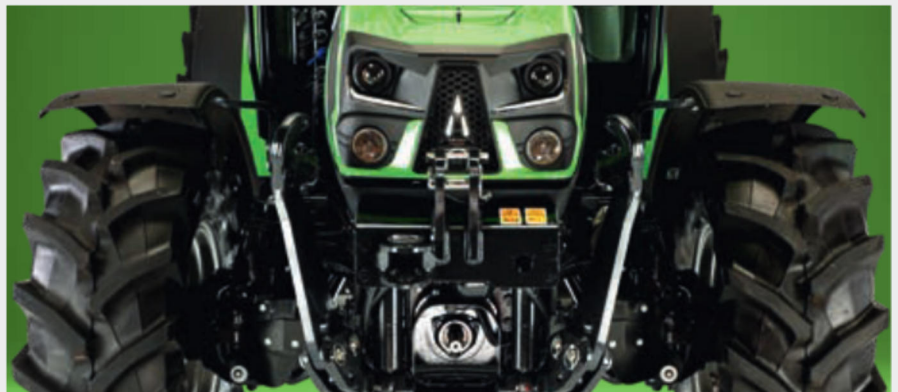
↑ 5D TTV-Modelle können mit einem Frontkraftheber mit 2.880 kg Hubkraft und optionalem Komfortpaket ausgestattet werden.
