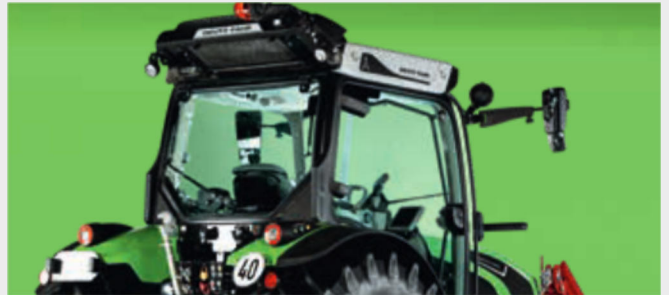
↑ Hinteres Dachteil ausstellbar, um beste Sicht nach hinten oben zu gewährleisten.
