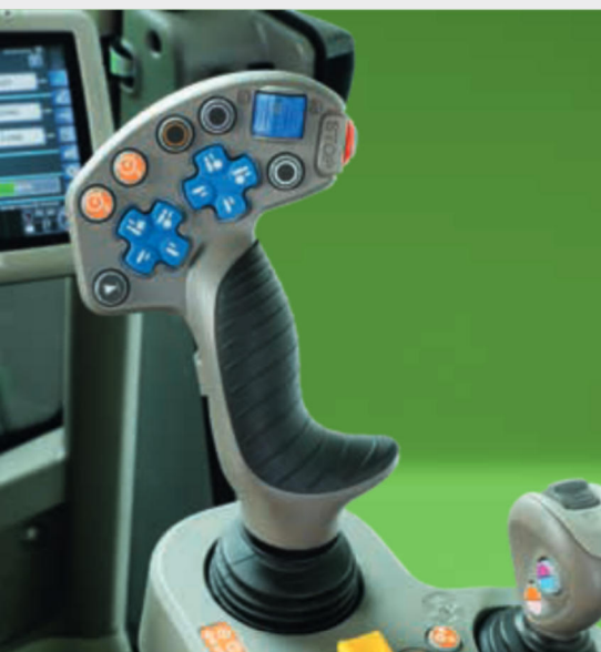
↑ MaxCom-Joystick für das einfache Management des TTV-Getriebes.
